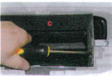
**4.** Montare e fissare la gabbia metallica (C) avendo cura di posizionarla correttamente e facendola appoggiare sulla spugna.
